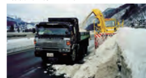
ロータリー除雪車とダンプトラックによる排雪作業
