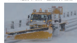
除雪トラックによる除雪作業
